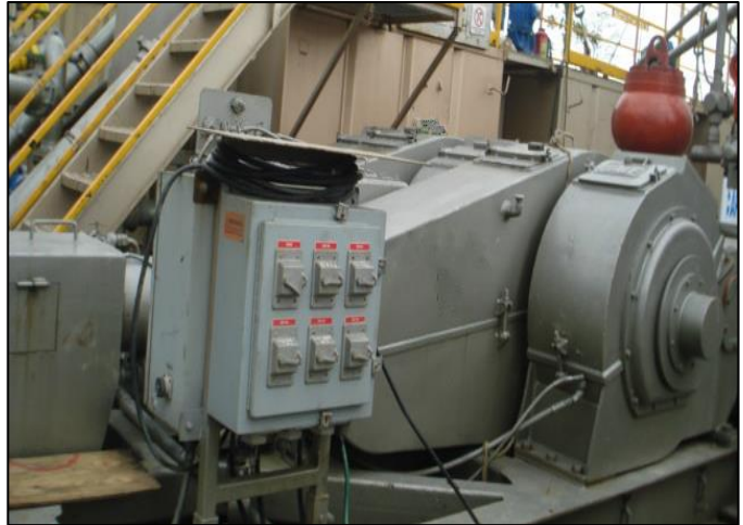
Figura 2.19: Bomba de lodos triple (3 pistones)
