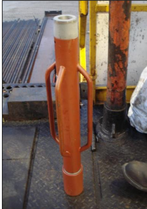
Figura 2.26: Centralizador para casing 9 5/8" OD
