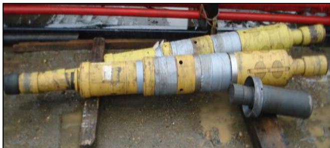
Figura 2.35: Empacaduras para casing de 9 5/8”
