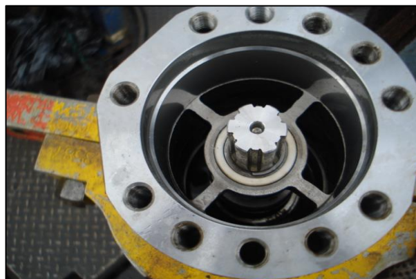
Figura 2.30: Eje de la bomba
