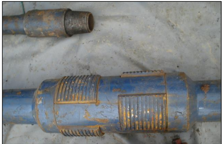
Figura 2.23: Scraper o raspatubo de diámetro 9 5/8”
