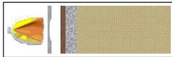
Fig.1 Carga, porta carga, revestidor, cemento y formación antes del disparo.
