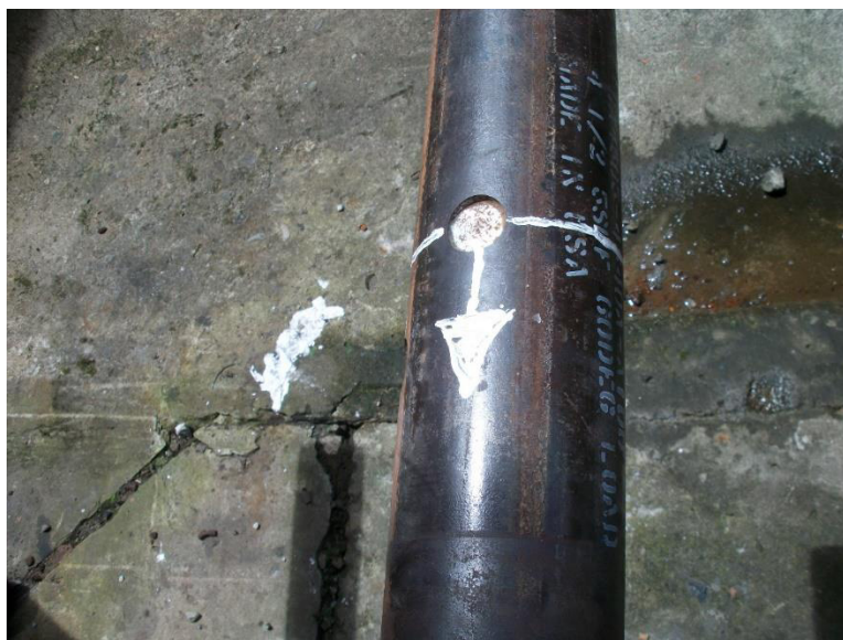
Figura 1.31 Marcar Primer Disparo en el Cañón
