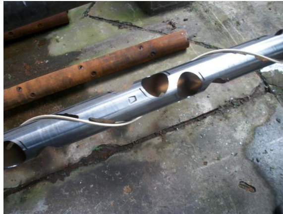
Figura 1.29 Portacargas Rodeado Por Cordón Detonante
