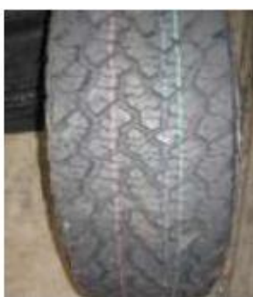
FIGURA 1.5.A BANDA CON ACANALADURA EN SENTIDO TRANSVERSAL
