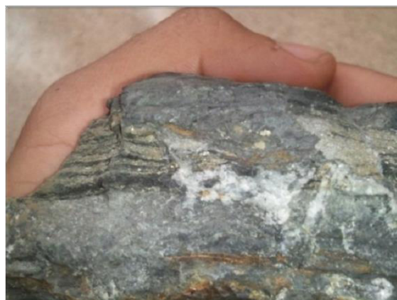
Foto.- 15 Roca metamórfica con alineación de la mineralización de pirita y cuarzo en la coordenadas 774065, 9789708
