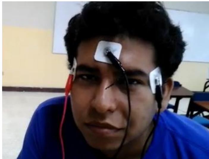
FIGURA 3.4.- Montaje del Electrodo “Posición Horizontal”
