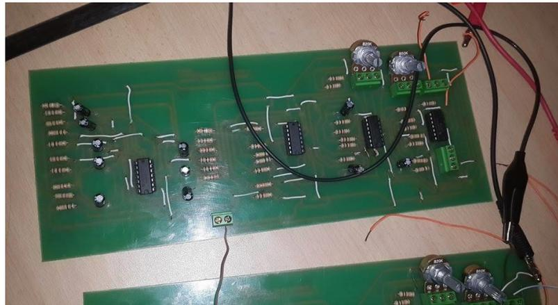
FIGURA 3.7.- Placa de Amplificación y filtrado (EOG)
