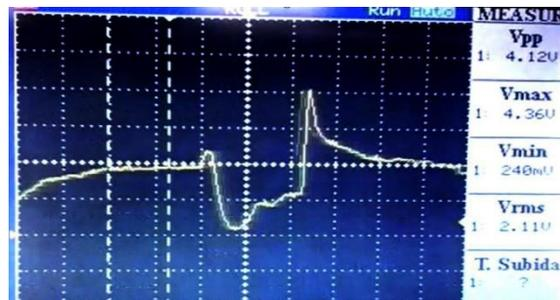
FIGURA 4.4.- Señal EOG de mirada abajo
