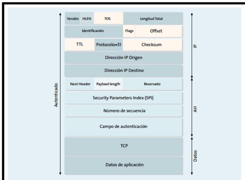
Figura 2.5 Estructura de un diagrama AH [4]
