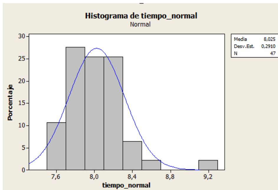
**Figura 3.12** Histograma de tiempo de transmisión – condiciones normales- RIPNG
