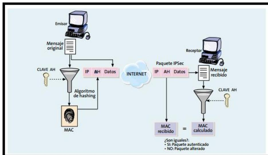
**Figura 2.6** Funcionamiento del protocolo AH [4]
