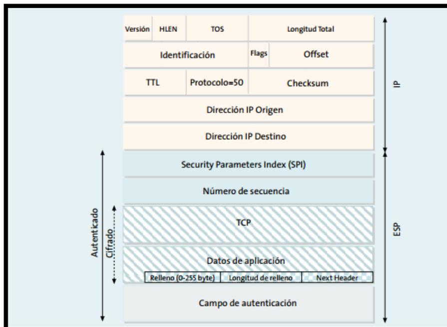
**Figura 2.9** Estructura de un diagrama ESP [4]
