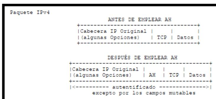
**Figura 2.3** Paquete IPv4 antes y después de emplear AH [3]
