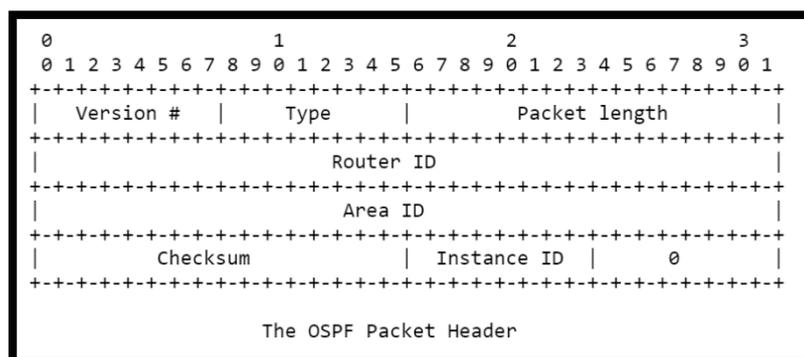
**Figura 2.1** Formato del encabezado de un paquete OSPFv3 [1]
