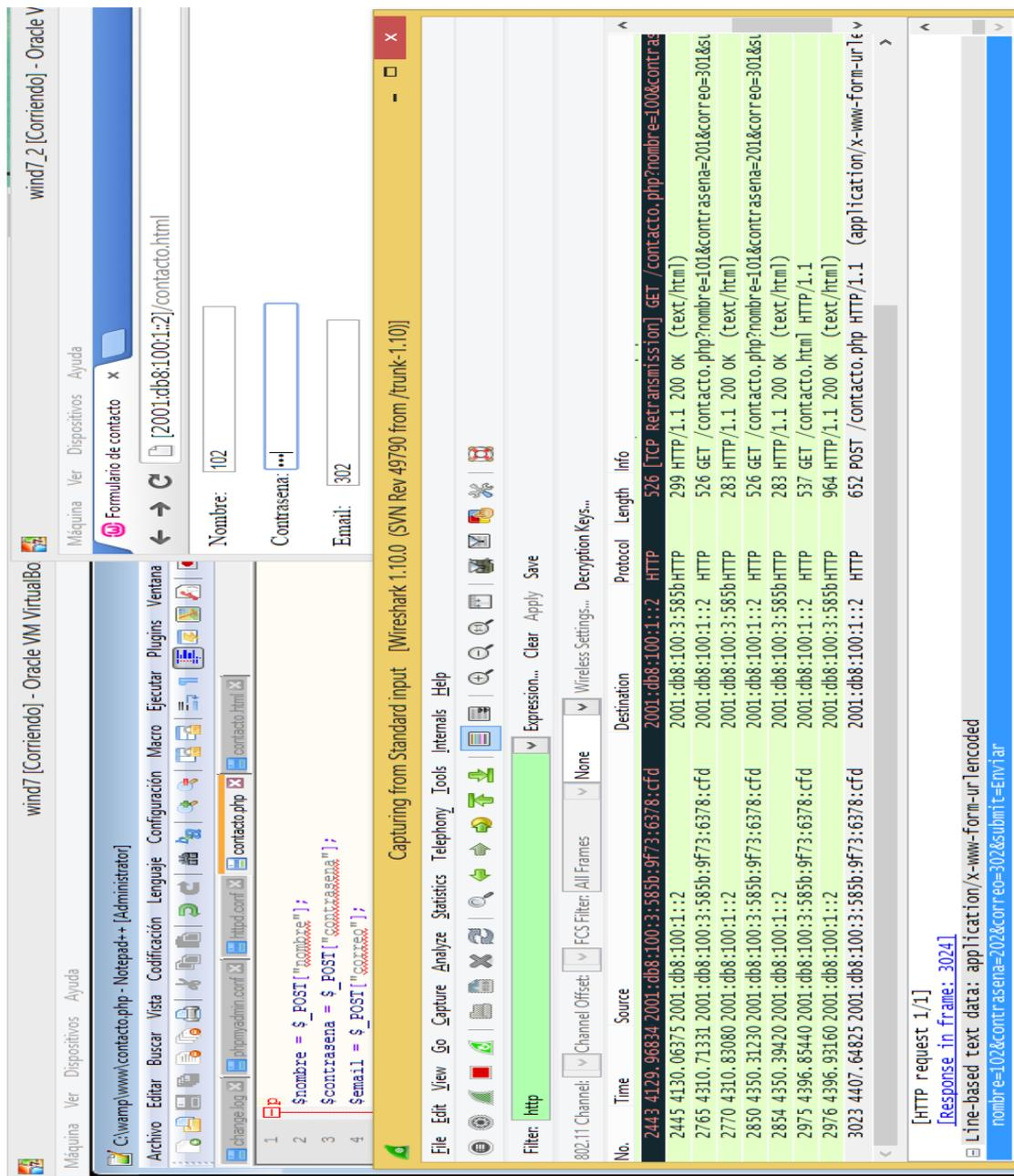
En el caso anterior el atacante pudo ver la información transmitida debido a que no había ninguna tecnología de seguridad configurada en la red. En cambio, cuando tenemos una VPN configurada y un atacante de alguna manera logra capturar los datos, solo podrá observar los paquetes con
