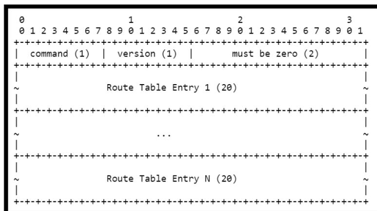
**Figura 2.2** Formato del encabezado de un paquete RIPNG [2]
