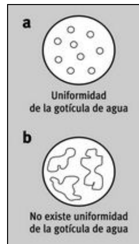
FIGURA 1.11 UNIFORMIDAD (a), NO UNIFORMIDAD (b) DE LAS GOTICULAS DE AGUA FUENTE [2]
