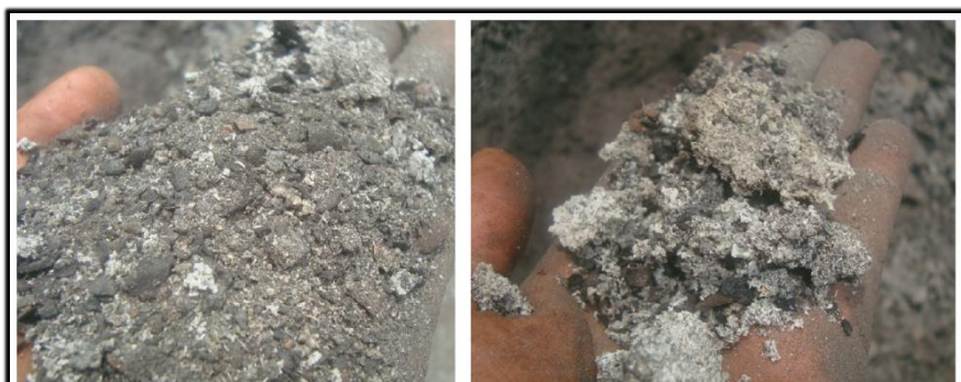
FIGURA 3.9 TIPO DE CENIZA CRISTALIZADA, OBTENIDA DEL HOGAR DEL CALDERO.
