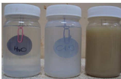
FIGURA 3.43 ENVASES PREPARADOS PARA EL ENSAYO EN UN AMBIENTE ACUOSO
