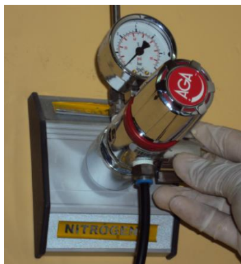
FIGURA 3.34 APERTURA DE VÁLVULA DE NITRÓGENO
