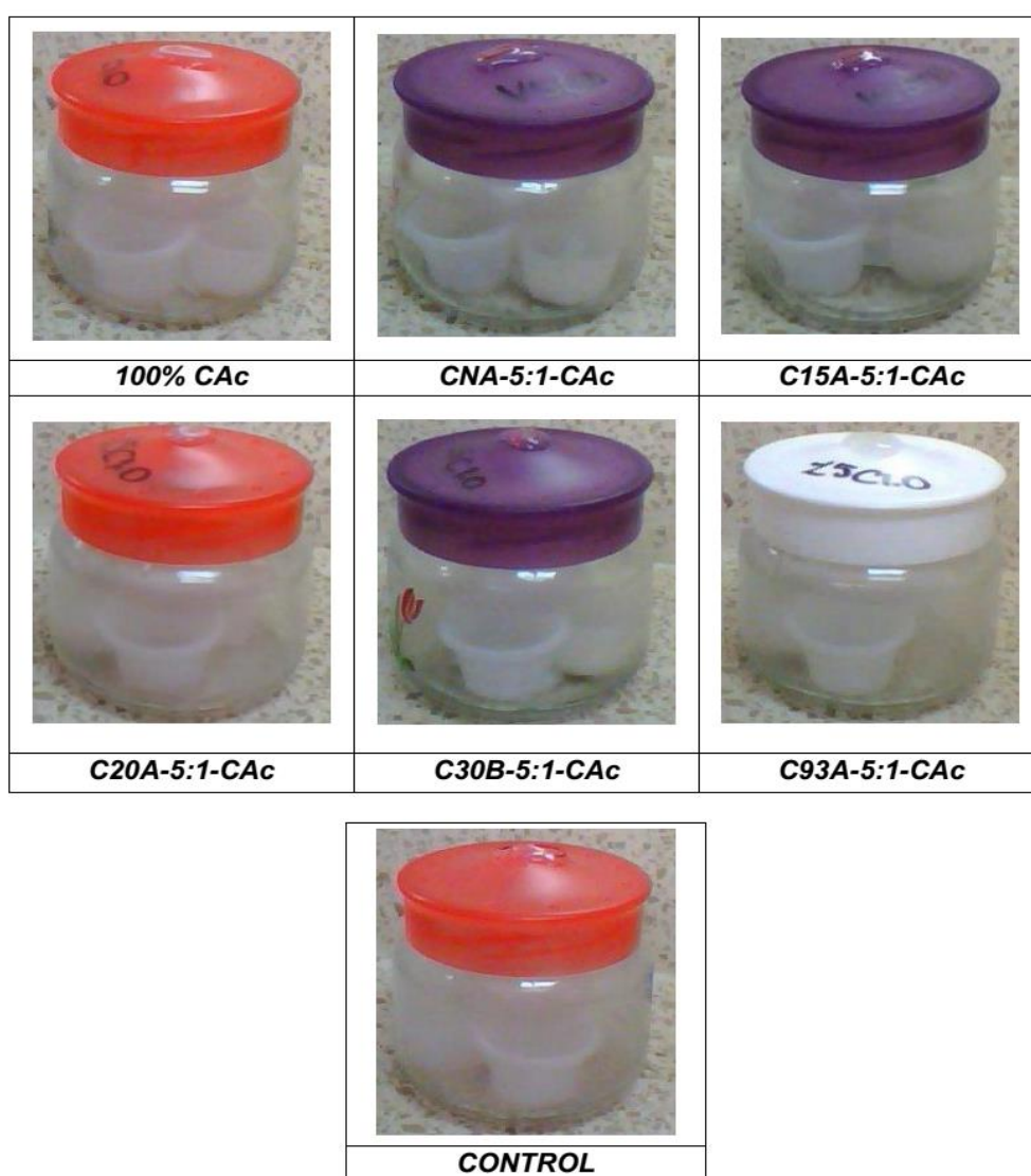
FIGURA 3.40 FORMACIÓN DEL AMBIENTE CORROSIVO GASEOSO
