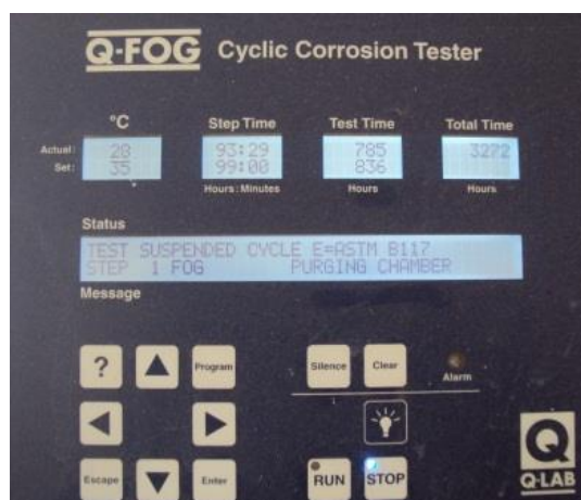
FIGURA 3.37 PANEL DE Q-FOG CON LA CONFIGURACIÓN DEL ENSAYO
