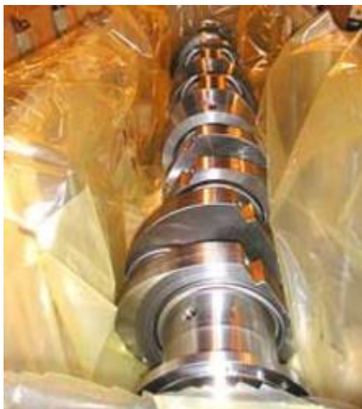
FIGURA 2. 10 APLICACIÓN DE INHIBIDORES VCI
