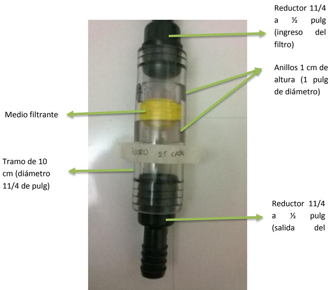
**Figura 3.1 Unidad de filtración**
