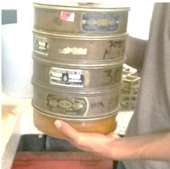
*Figura 3.7 Tamizado de la muestra*
