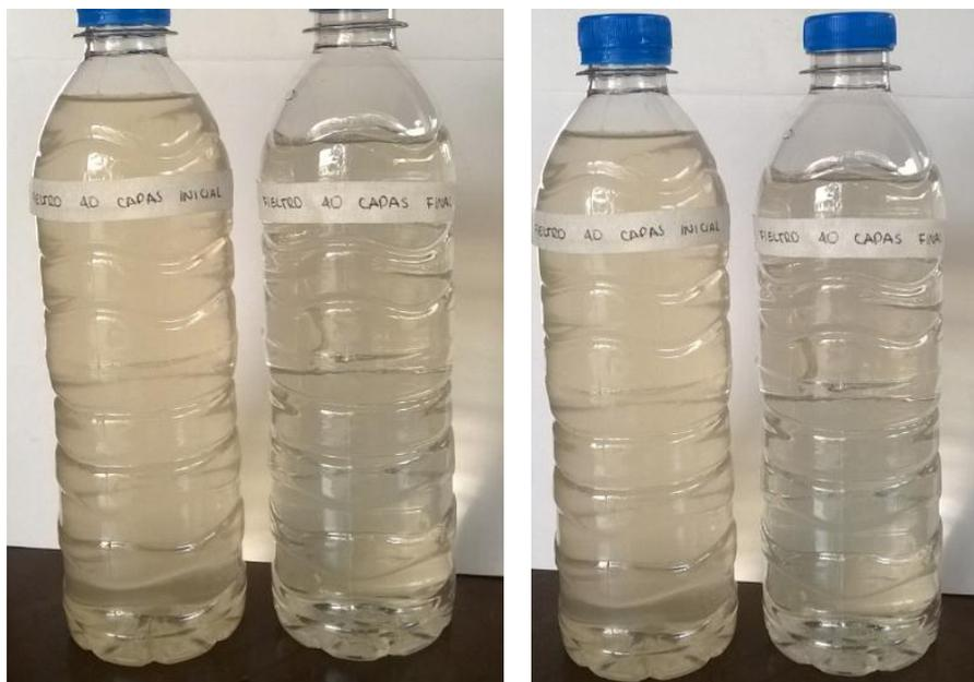
***Figura C 10 Cambio obtenido con Filtro dispuesto en 40 capas***
