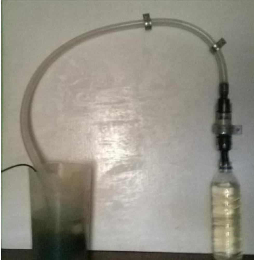
***Figura C 7 Sistema de filtración funcionando***
