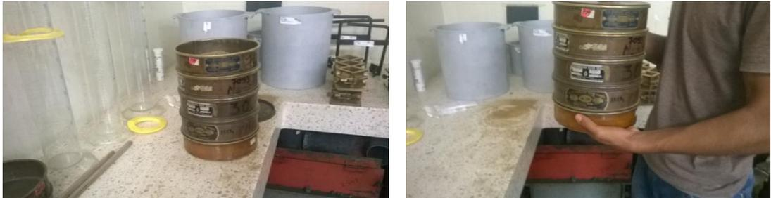
***Figura C 13 Tamizado para obtener muestra pasante 200***
