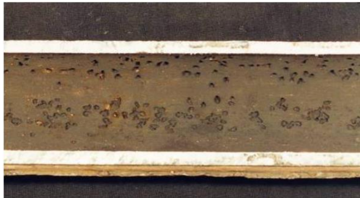
FIGURA 2.9 MECANISMO FALLA POR PICADURA.
