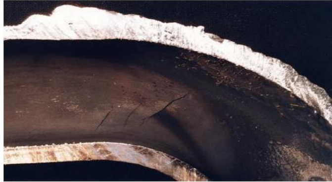
FIGURA 2.10 MECANISMO DE FALLA CORROSIÓN BAJO ESFUERZO.
