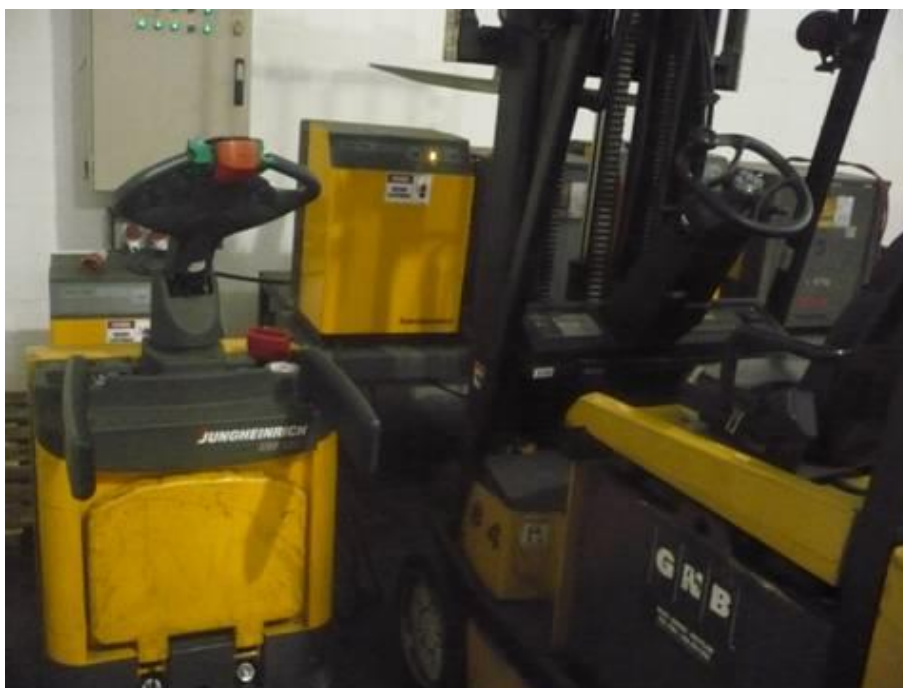
Figura 2.11 Ejemplo de un acto sub estándar al no desmontar la batería, se observa cómo se conecta directamente del vehículo al cargador.
