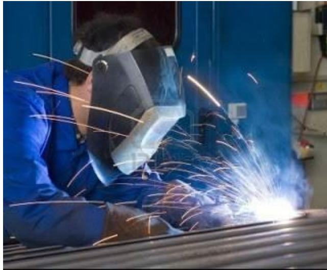
Figura 1.1 Se debe evitar las chispas de equipos eléctricos de soldar en los locales de carga de baterías.
