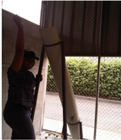
FIGURA 3.5. REPRESENTACIÓN DE LA PRUEBA DE IMPACTO DE CAIDA LIBRE.
