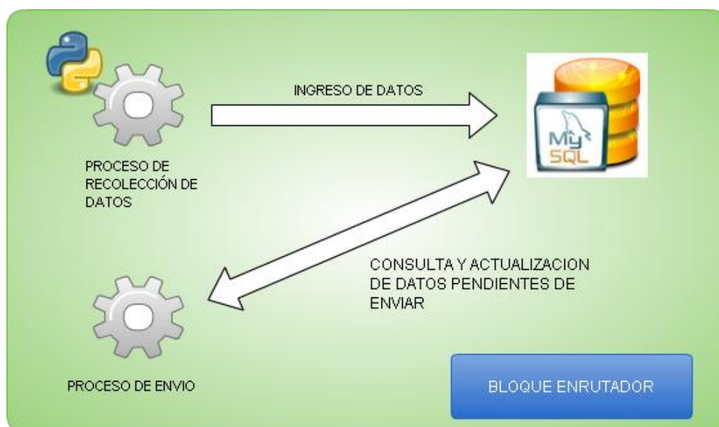
Figura 3.4 Diagrama de Bloque del Enrutador
