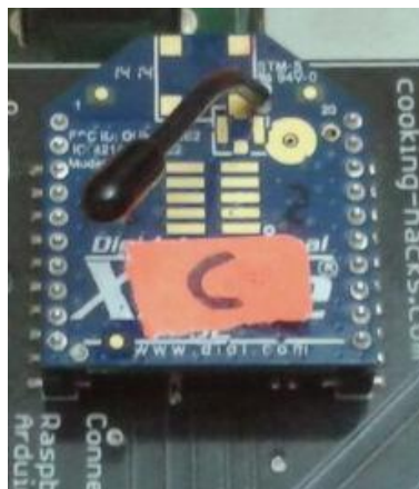
Figura 0.9 Xbee Series 2 configurado como coordinador
