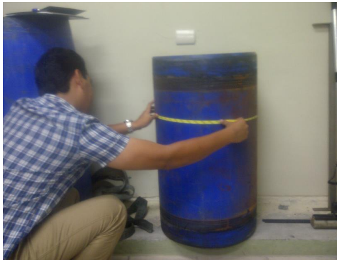
Figura 2. Forma correcta de usar la cinta Pi- Tape
