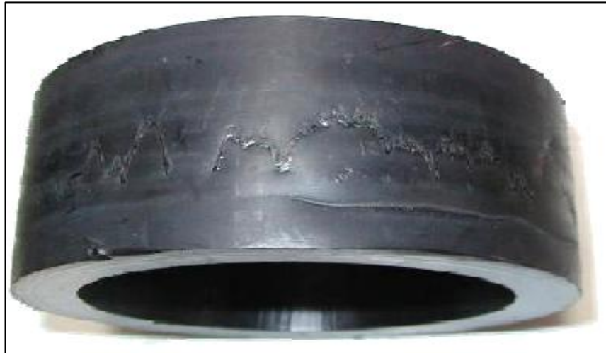
FIGURA 2.5 HUELLAS DE FLUIDO EN LA TUBERÍA
