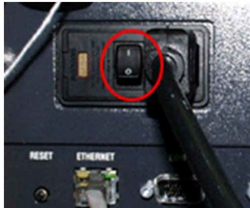
Figura 1. Botón de encendido del equipo SDT Q-600
