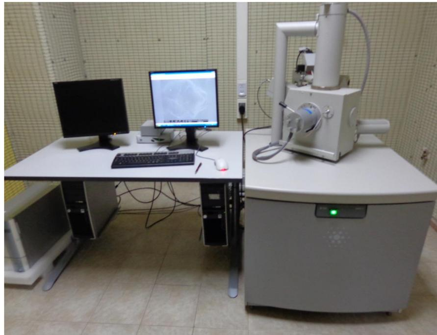
**FIGURA 3.10 MICROSCOPIO ELECTRÓNICO DE BARRIDO
