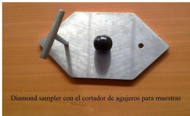
**FIGURA 3.20 DIAMOND SAMPLER CON CORTADOR DE AGUJEROS PARA MUESTRAS.**
