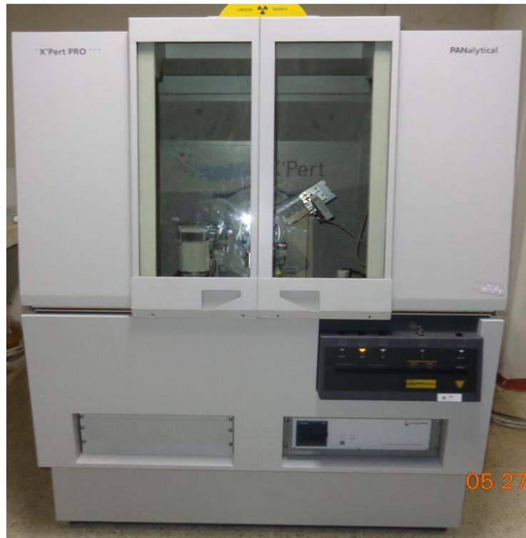
**FIGURA 3.1. DIFRACTÓMETRO DE RAYOS X.**
