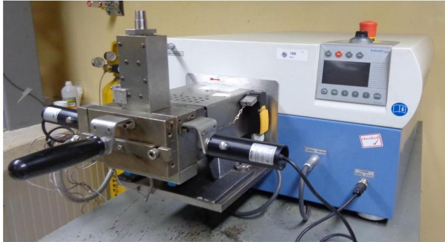
**FIGURA 3.13 PLÁSTOGRAFO DE 2 TORNILLOS PARA PRUEBAS DE LABORATORIO.**
