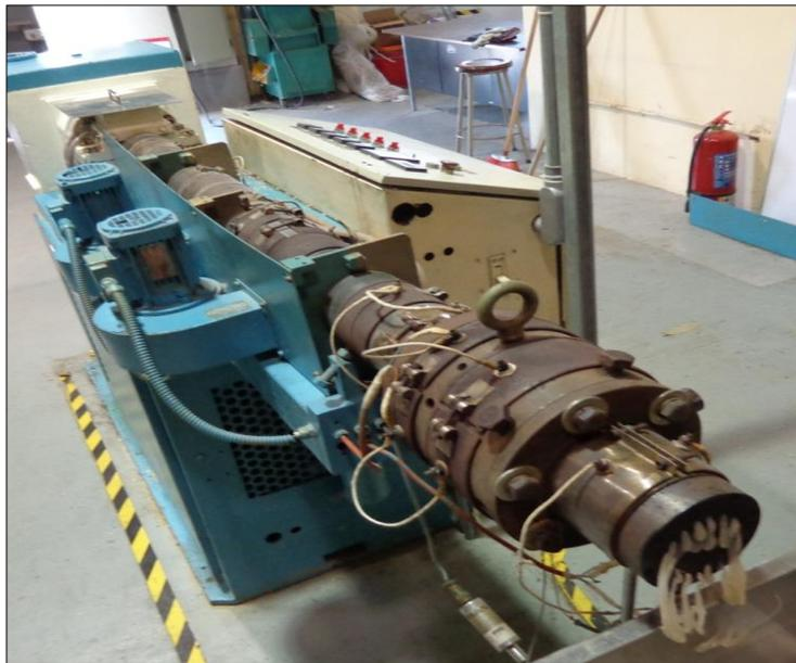
**FIGURA 3. 14 EXTRUSORA DE TORNILLO SIMPLE MODIFICADA.**
