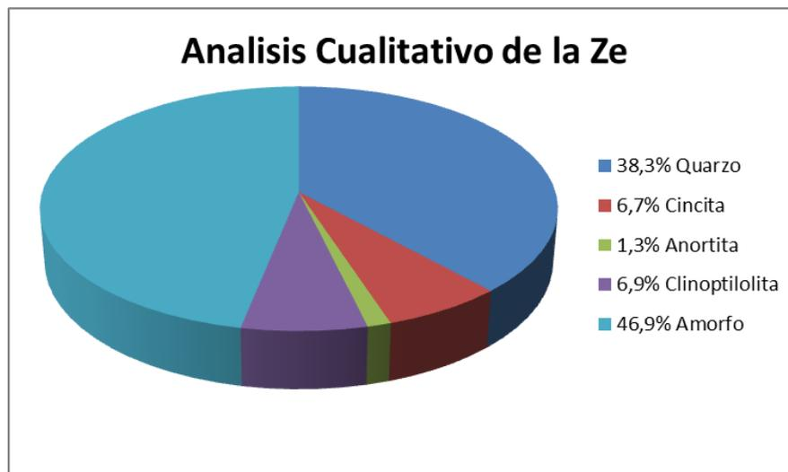
**FIGURA 4.1 GRÁFICA DE RESULTADO CUANTITATIVO DEL DIFRACTOGRAMA DE ZEOLITA NATURAL ECUATORIANA**
