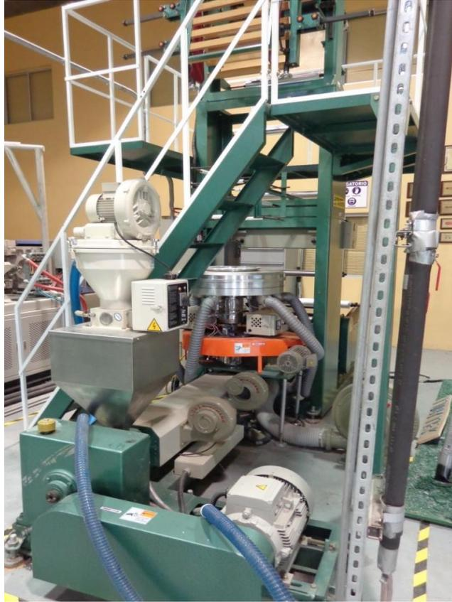
**FIGURA 3.15 EXTRUSORA DE PELÍCULAS**
