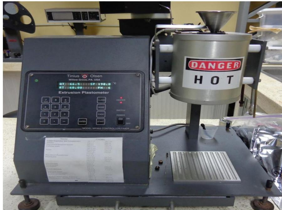
**FIGURA 3.12 PLASTÓMETRO DE EXTRUSIÓN**
