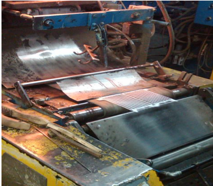
FIGURA 3.25 BANDA TRANSPORTADORA DE REJILLAS
