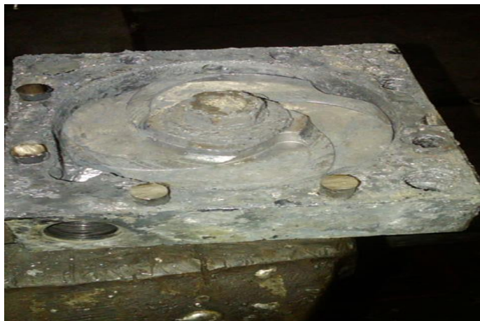
FIGURA 3.3 DAÑO DE IMPULSOR DE BOMBA POR CONTAMINACIÓN DE ESCORIA
