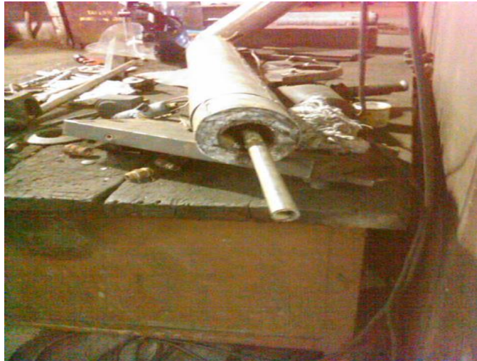
FIGURA 3.4 TAPONAMIENTO DE TUBOS DE ALIMENTACIÓN
