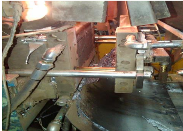
FIGURA 3.8 DAÑO DE BOTADORES
