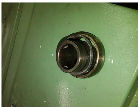
FIGURA 3.5 DAÑO DE RODAMIENTO POR FALTA DE LUBRICACIÓN
