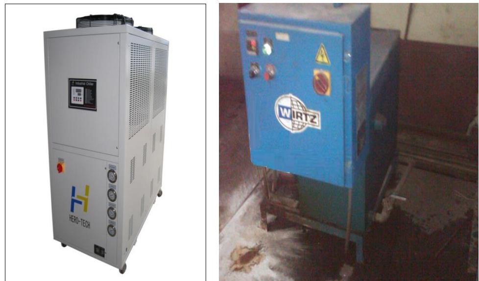
FIGURA 3.22 SISTEMA DE ENFRIAMIENTO DEL MOLDE (CHILLER Y CCS)
