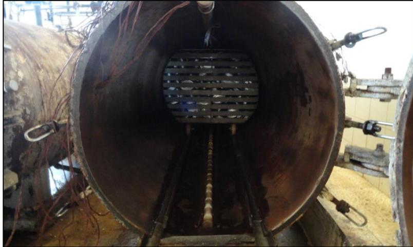
**FIGURA 2.2 AUTOCLAVE HORIZONTAL DE VAPOR**
