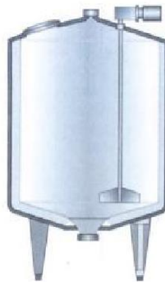
FIGURA 3.17 TANQUE DE MEZCLA
