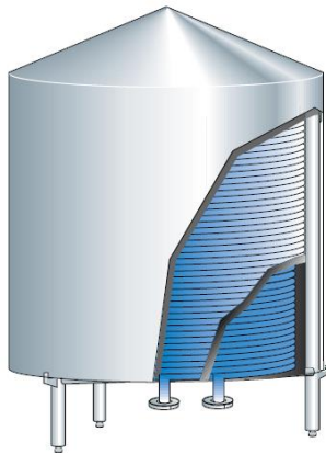
FIGURA 5.4. TANQUE DE RETENCIÓN
