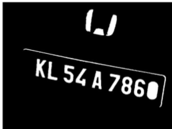
Figura 2.8: Componentes conectados [1]
