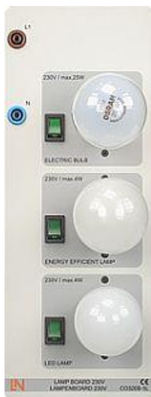
Figura 2.18 Panel de lámparas de 230V (CO3208-1L). [1]
