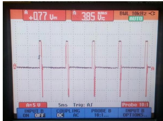
Figura 3.44 PWM enviado al motor para el control de velocidad
