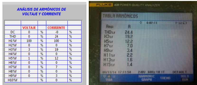
Figura 3.37 Datos de armónicos obtenidos por la CompactDAQ y por el analizador de calidad de energía Fluke modelo435
