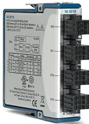
Figura 2.30 Módulo de entrada analógica simultánea NI 9219. [34]
