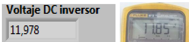
Figura 3.40 Voltaje en la entrada del inversor monofásico obtenido por la CompactDAQ y por el multímetro Fluke87V.
