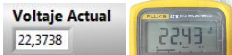
Figura 3.38 Voltaje del panel solar obtenidos por la CompactDAQ y por el multímetro Fluke87V.
