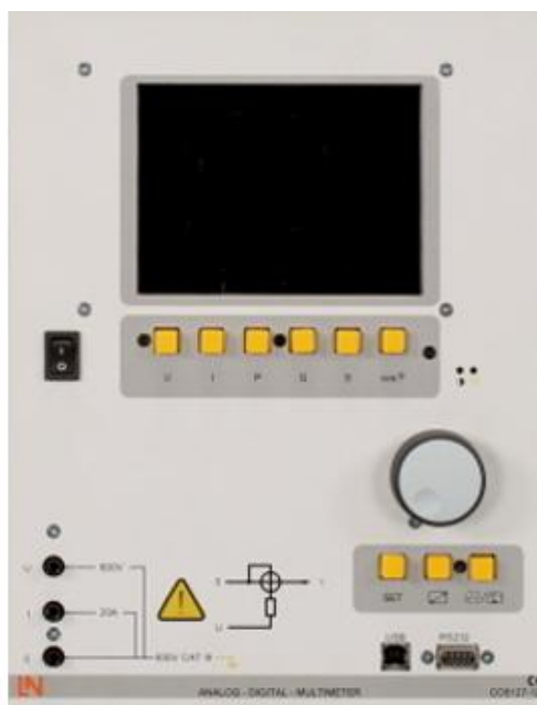
Figura 2.21 Multímetro analógico/digital (CO5127-1Z). [1]
