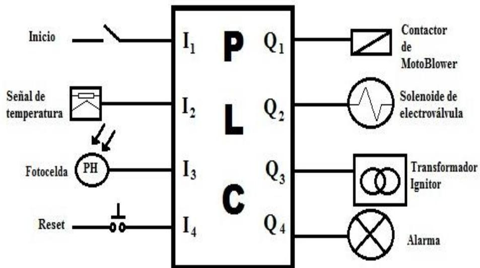
Figura 4.4 Diagrama de conexión de los elementos del quemador con el PLC
