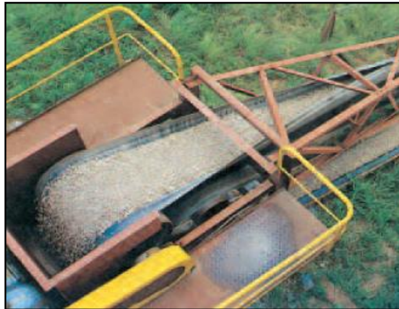
FIGURA 1.10 SECCIÓN DE DESCARGA [7]
