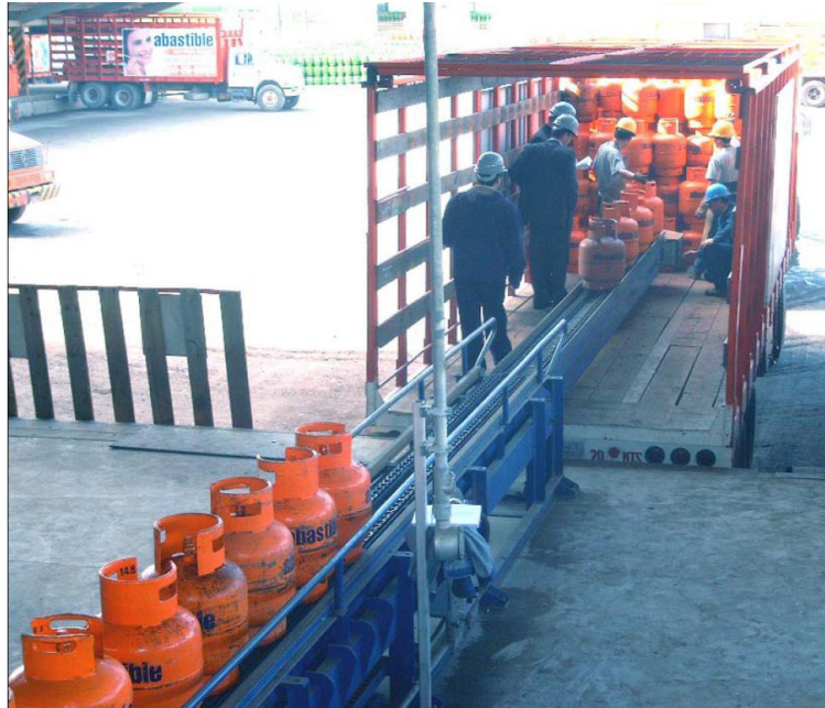
FIGURA 1.17 ALTERNATIVA “A” SISTEMA TELESCÓPICO [7].
