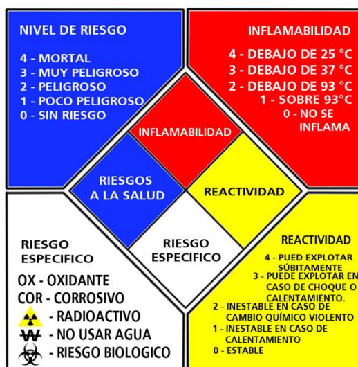
FIGURA 1.1 ROMBO DE SEGURIDAD NFPA 704 [3]
