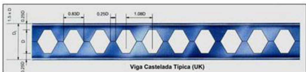
FIGURA 3.6 DIMENSIONAMIENTO DE AGUJEROS. [22]
