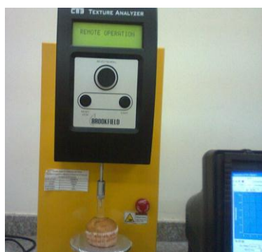
Fig. 3.4 Medición en Equipo Texturómetro
