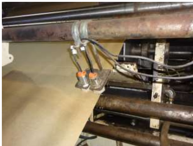
Figura 3.7 Sensores de nivel y humedad
