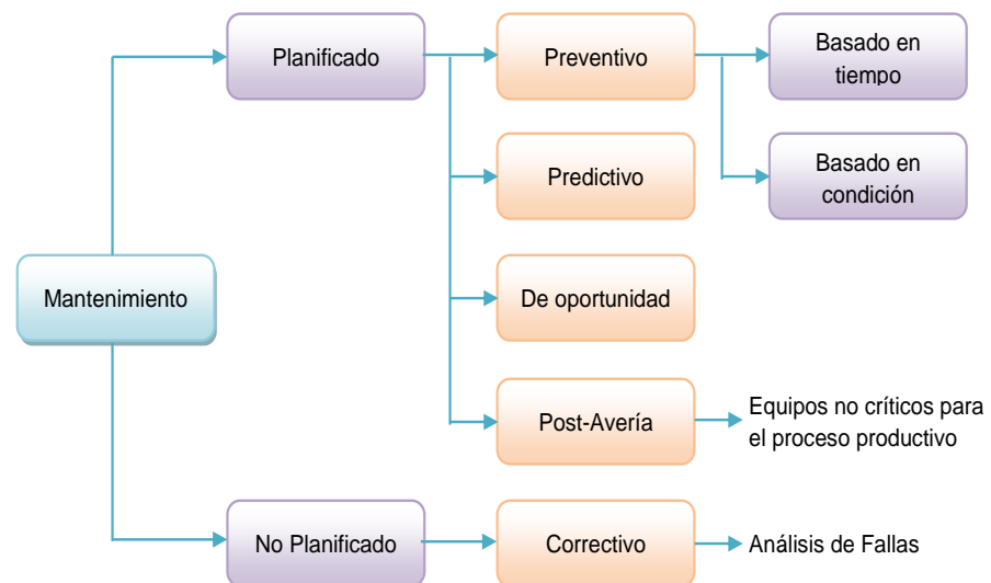
FIGURA 2.2 TIPOS DE MANTENIMIENTO
