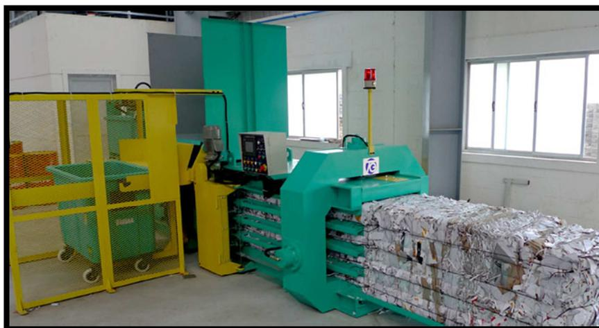
**FIGURA 2.7 SISTEMA DE EMPACADO DE DESPERDICIOS.**
