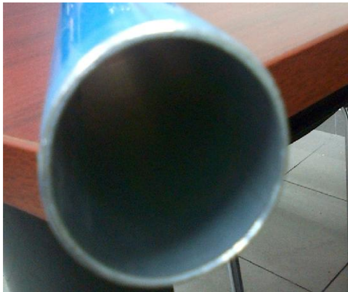
FIG. 4.3 TUBERÍA DE ALUMINIO DE 40MM DE DIÁMETRO
