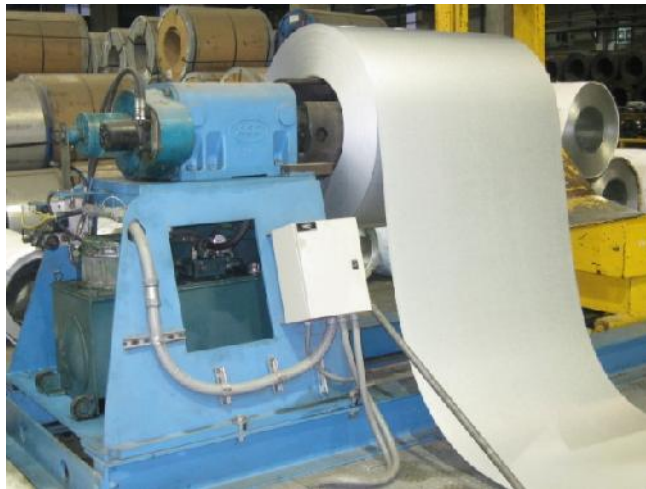
FIG. 2.4 DESBOBINADOR DE 8 TONELADAS DE CAPACIDAD
