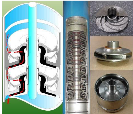
Figura 2.10 Bomba electro sumergible Fuente: Fernando Escandon – Petroamazonas EP
