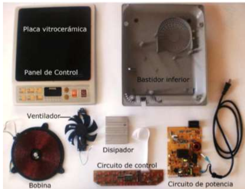
FIGURA 2.2 PARTES DE LA COCINETA A INDUCCIÓN
