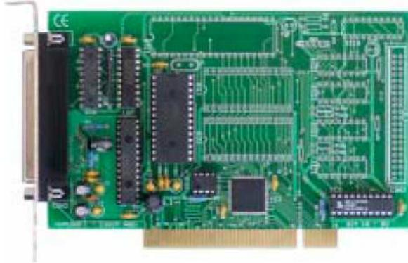
FIGURA 4.1 TARJETA DE ADQUISICIÓN DE DATOS PCI
