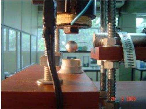
Podemos observar el sistema en funcionamiento, con la esfera levitando.
