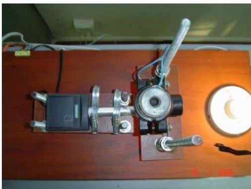
Una vista superior de la planta. Se observa a la izquierda el sensor, en el centro la bobina y a la derecha la fuente de luz.
