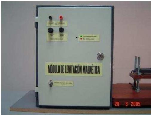
Este armario contiene las fuentes de poder para alimentar la bobina y el sensor. Contiene también el interruptor principal que alimenta a toda la planta, y un interruptor para la bobina.
