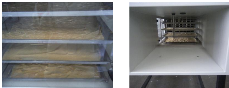
FIGURA 2.3 DISPOSICIÓN DE LAS BANDEJAS EN EL SECADOR
