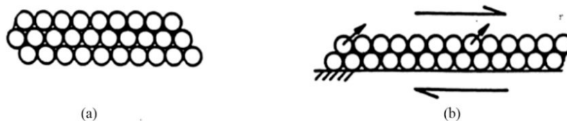
Ilustración 2.5 Aumento de volumen debido al corte.[11]
