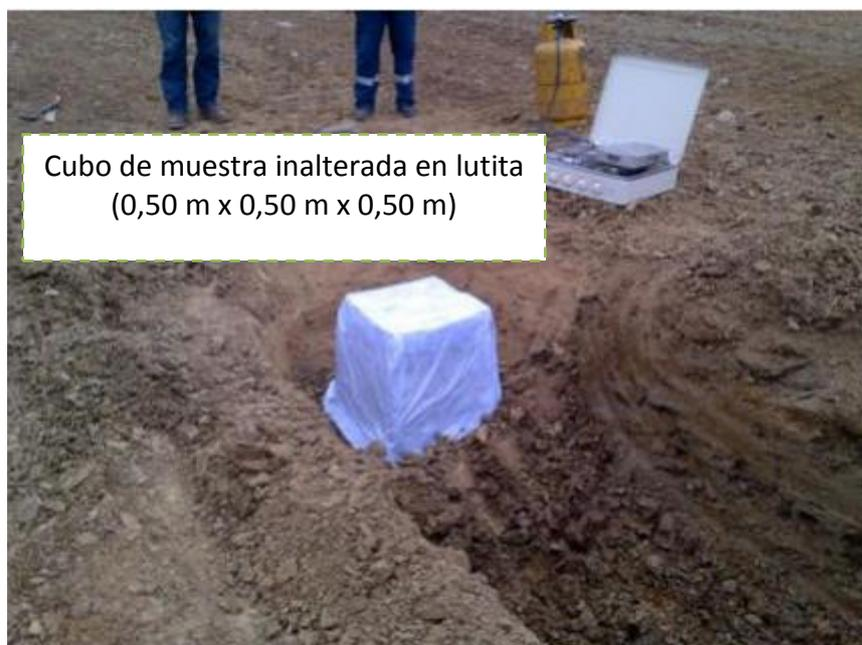
**Fotografía 13.** Extracción de muestra inalterada en lutita del JOBO 1
