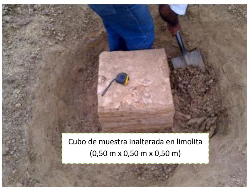
**Fotografía 12.** Extracción de muestras inalteradas en limolita del JOBO 1
