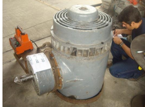
FOTO 3.- REDUCTOR DE VELOCIDAD
