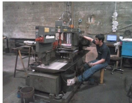
FOTO 5.- EJE DE ACERO INOXIDABLE EN CORTE
