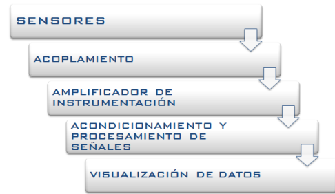
Figura 1. Etapa de diseño del circuito
