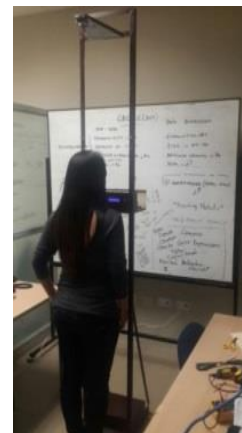
Figura 14. Estructura para medir estatura y peso
