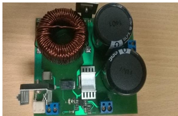
Figura 25. Hardware implementado de la etapa AC–DC con PFC Boost.
