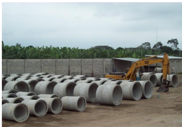
FIGURA 3.4.- TUBERÍAS DE HORMIGÓN ARMADO
