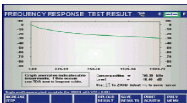
Figura 34: Respuesta de Frecuencia Fuente: Consultronics CableSHARK XDSL
