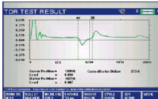
Figura 35: EL REFLECTOMETRO Fuente: Consultronics Cable Shark XDSL
