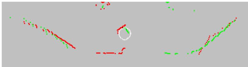
Figura 4.2.9 Ejemplo de imagen de perfil en la cual la tubería viene localizada correctamente luego del procedimiento de discontinuidad en rango.
