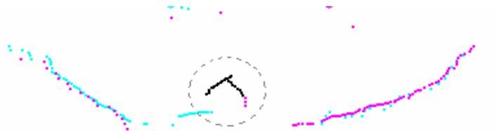
Figura 3.3.17 Perfil final de la tubería obtenido (en negro) usando la información de ambos sensores sonar.
