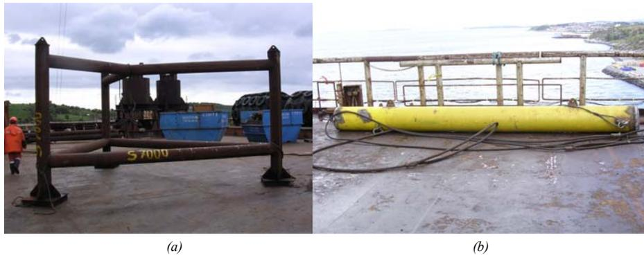
Figura 3. Estructuras usadas para realizar las pruebas submarinas con el sistema haz de abanico. (a) estructura "estrella-triángulo"; (b) tubería
