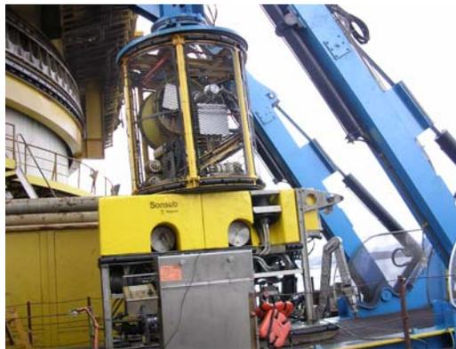
*Figura 2. Vehículo Operado Remotamente (VOR). En la parte inferior se instalan los transductores sonar.*
