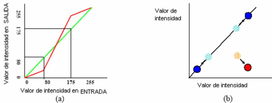
Figura 2.2.7 (a) ejemplo de función de mapeo de intensidad; (b) efecto de la aplicación de la función de mapeo de intensidad sobre los pares de intensidad
