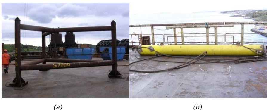
Figura 4.1.1 Estructuras usadas para realizar las pruebas submarinas en las cuales fue empleado el sistema sonar *haz de abanico*. (a) estructura "estrella-triángulo" (b) tubería
