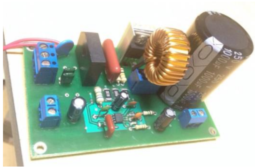
Figura 24. Tarjeta electrónica de la etapa AC-DC (Convertidor Boost PFC).
