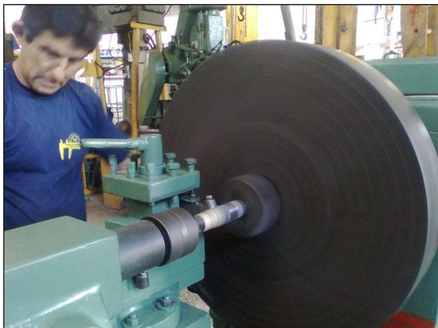
**Figura 3.19: Maquinado final del eje rociado**
