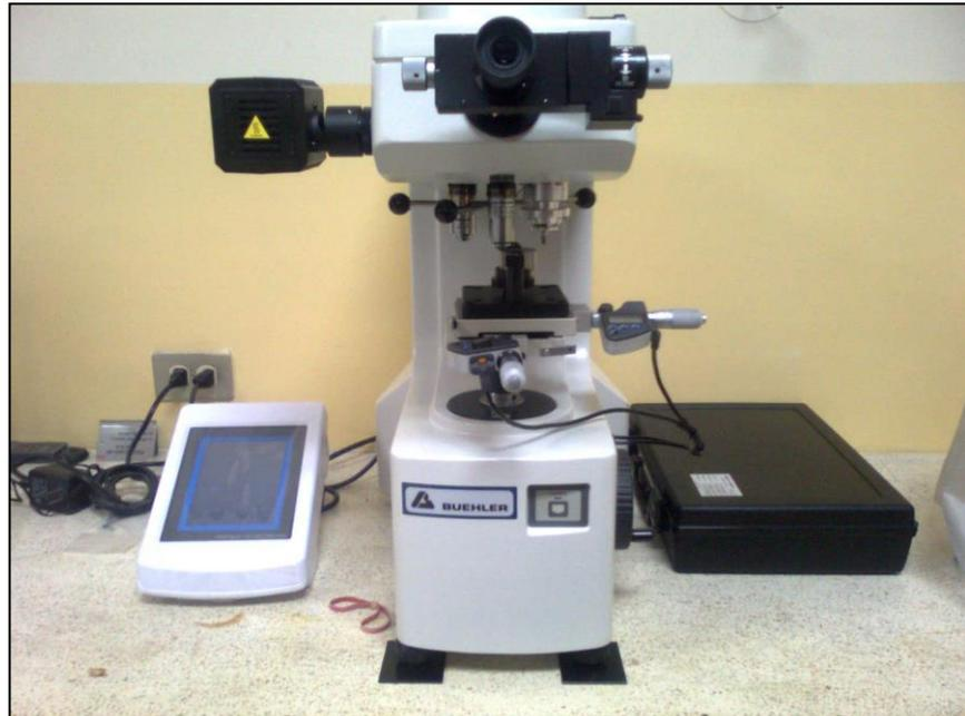
**Figura 3.5: Equipo utilizado para medir la dureza**
