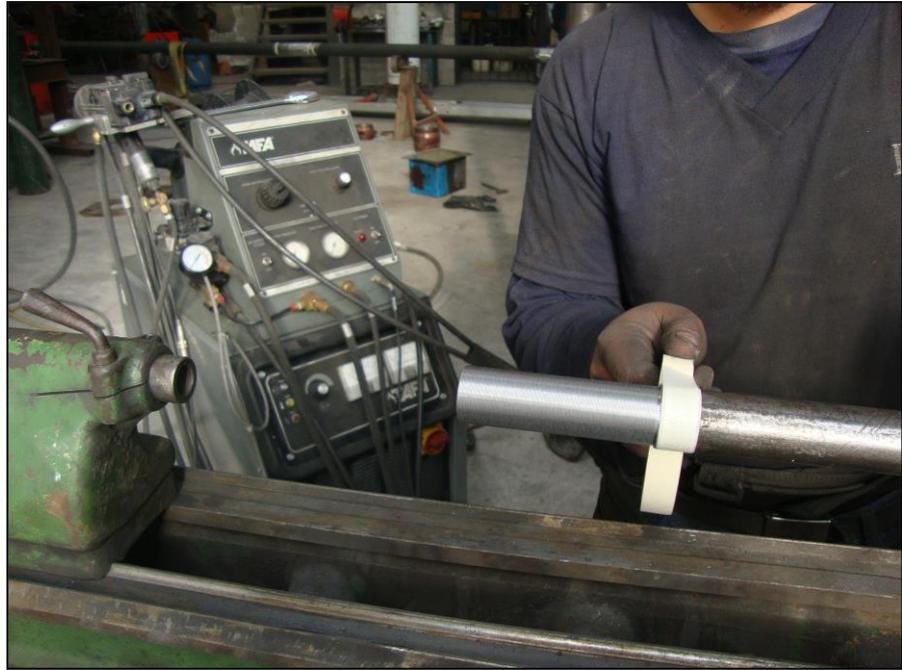
**Figura 3.12: Protección del área adyacente a ser rociada**
