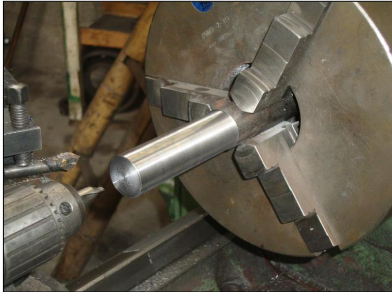
**Figura 3.7: Estado del eje después del mecanizado**
