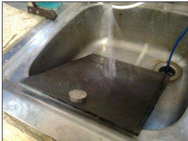
**Figura 3.1: Muestra sumergida en agua para el desbaste**
