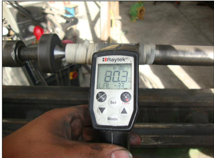
**Figura 3.17: Control de temperatura durante el rociado**
