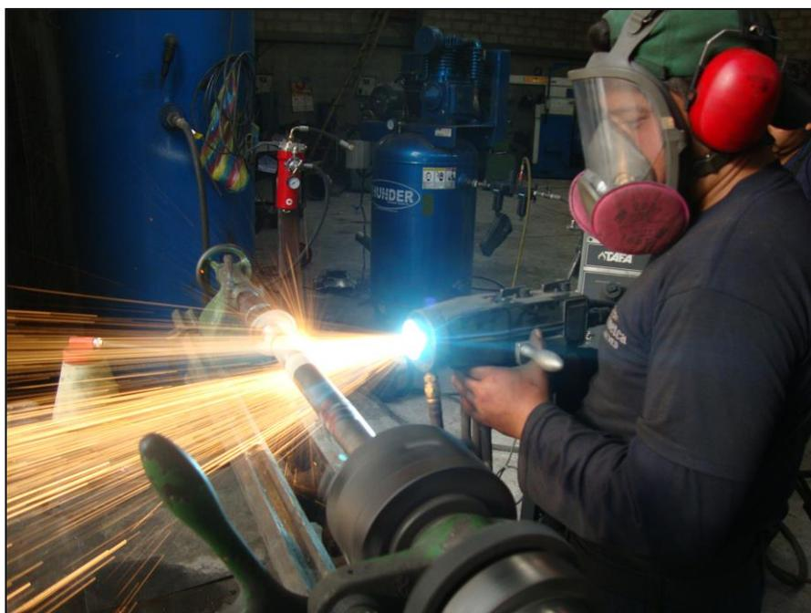
**Figura 3.13: Aplicación del alambre base BOND ARC 75B**
