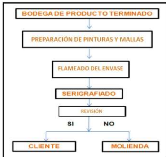
FIGURA 1.16 PROCESO DE SERIGRAFÍA
