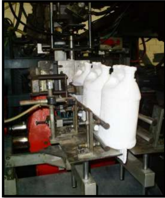
FIGURA 1.10: ENVASES POR EXTRUSIÓN SOPLADO
