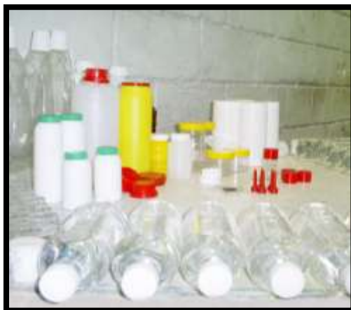
FIGURA 1.11: BOTELLAS POR INYECCIÓN SOPLADO
