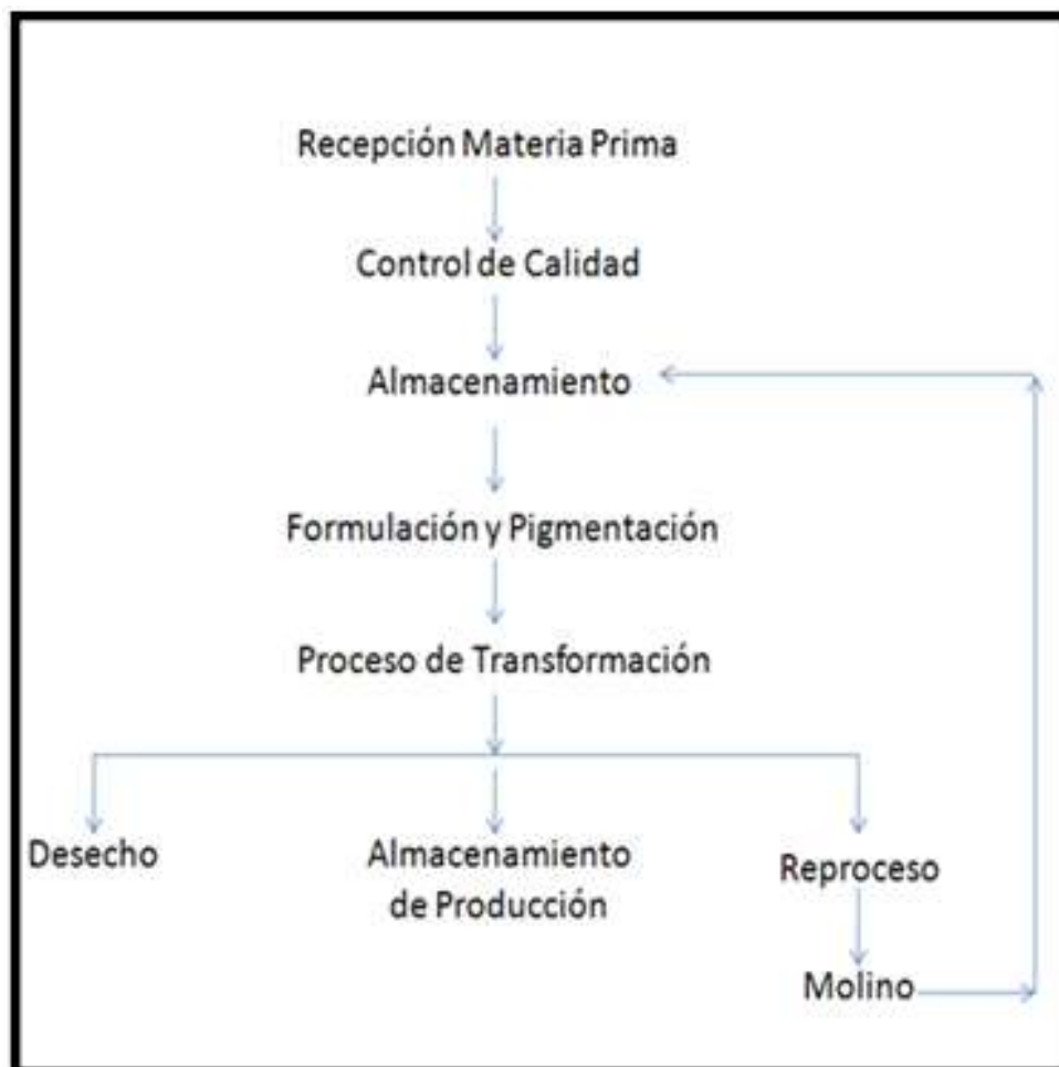
FIGURA 2.2: DIAGRAMA DE FLUJO DE LOS PROCESOS DE TRANSFORMACIÓN
