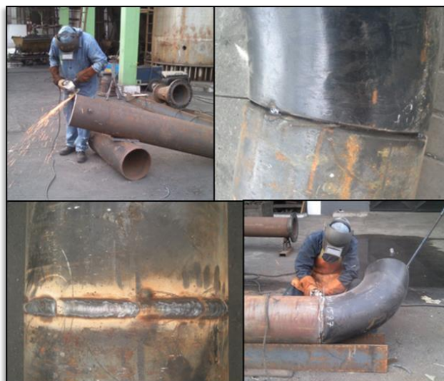
FIGURA 4.31. PROCESOS DE SOLDADURA DE LAS TUBERÍAS.
