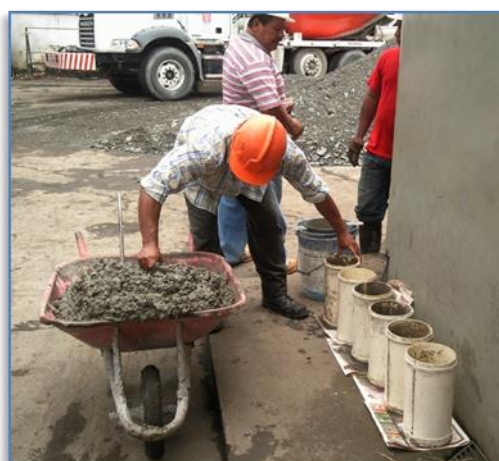
FIGURA 4.18. PREPARACIÓN DE CILINDROS DE HORMIGÓN.
