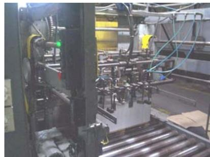
Figura 1. Alimentador de láminas
