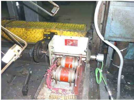
Figura 9. Sincronizador del horno
