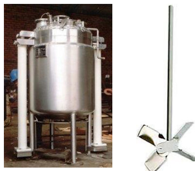
FIGURA 5. 5. MARMITA DE DOBLE CHAQUETA CON AGITADOR DE HÉLICE
