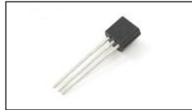
**Figura 3.3** Sensor de temperatura DS18B20
