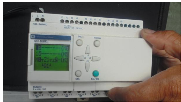
Figura 11. Programación directa del PLC
