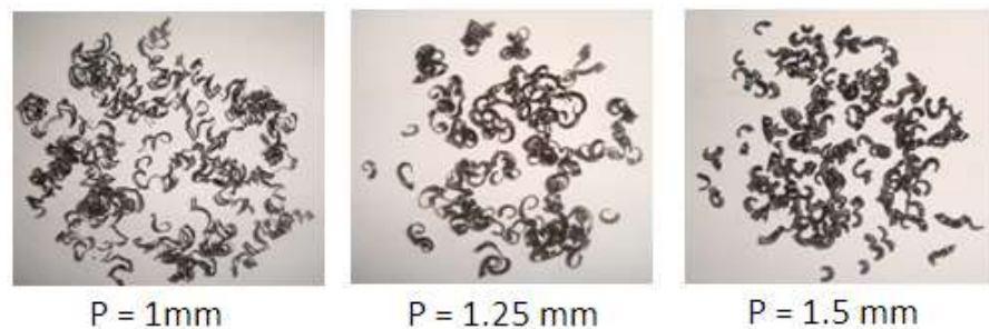
Figura 4.8. Formación de la viruta con la herramienta TNMG160404-PF GC4215 a distintas profundidades de corte
