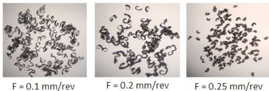
Figura 4.9. Formación de la viruta con la herramienta TNMG160404-PF GC4215 a distintos avances
