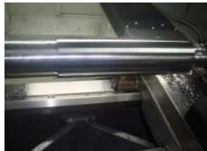
Figura 2.11 Chequear que el material este sin imperfecciones
