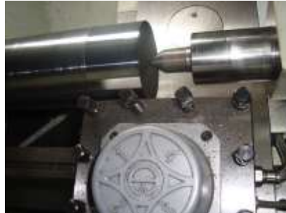
Figura 2.10 Fijación de la herramienta entre puntos.
